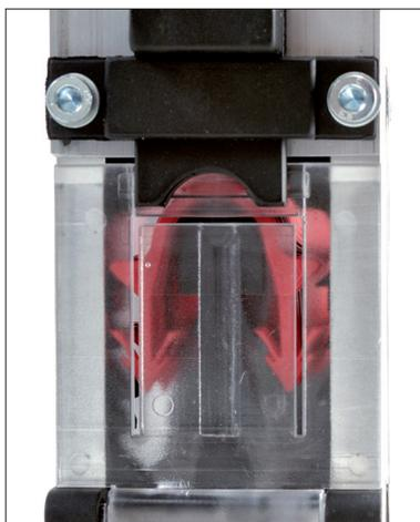
ClouSet® PAN Short Klammern bestehen aus schlagfestem Kunststoff. Die Befestigung des Systemheizrohres 18 x 2 mm und 20 x 2 mm auf der Systemplatten DES bzw. DEO funktioniert im Widerhaken-Prinzip. Das bedeutet, bei der Zugbelastung nach oben (z.B. bei Fliesestrich) spreizen sich die Widerhaken und bilden somit einen Halteverbund an der Unterseite der 250 µm starken PE-Folie. Estrichfeuchte kann in die Isolierung nicht eindringen.
