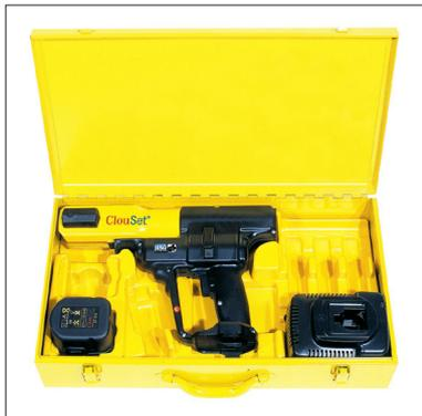
ClouSet® Akku-Presszange ACC Basic-Pack. Akku-Radialpresse zur Herstellung von Pressverbindungen aller gängigen Pressfitting-Systeme, Ø 10–76 (108) mm. Antriebsmaschine mit Zwangsablauf und Service-Elektronik, Akku, Schnellladegerät. Im stabilen Stahlblechkasten.
