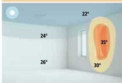
Heizung/Kühlung durch herkömmliche Luftkonvektoren
