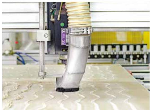
Produktion ClouTop Systemelemente mit lasergesteuerten CNC-Maschinen
